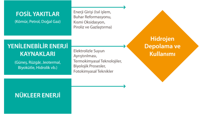
Şekil 4: Kaynaklarına Göre Hidrojen Üretim Yöntemleri
