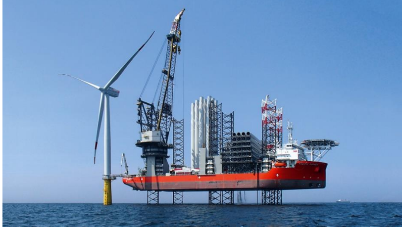
Şekil 4. Deniz Üstü Türbin Kurulum Gemisi Örneği Kaynak: DNV 31
