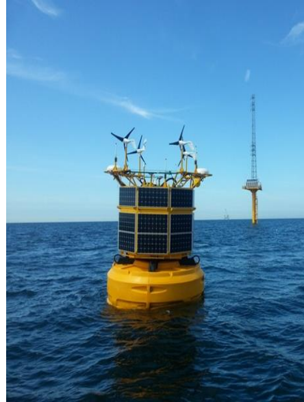
b) Yüzen LIDAR (Floating Lidar, FLidar) Kaynak: Axys Technologies 25
