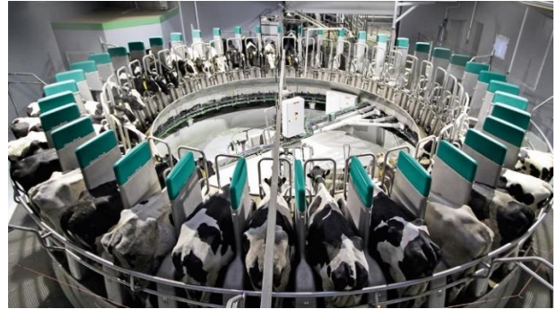
Şekil 15: Otomatik süt sağma makinası
